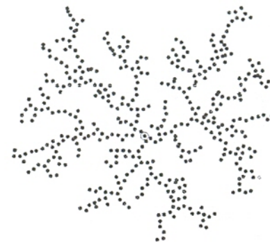
Fig. 1 Fraktala klastro ricevita per komputora modelo. Per rondeto estis markita la centro de klastrigo.
