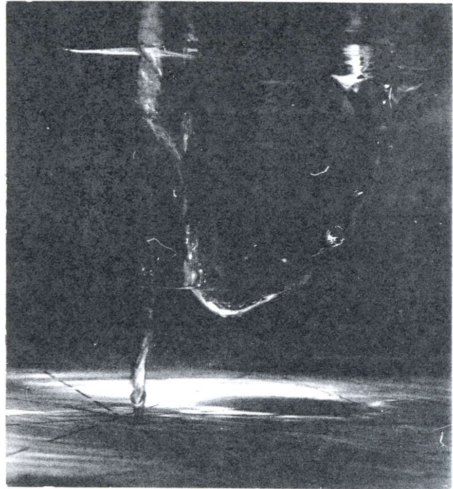
Bildo 2 : Dekstre: kurbaksa aerfunelo formiĝinta en kaj pro akvokirlo, kaj transportanta aeron en la maldekstran suĉtubon de la pumpilo. En la suĉtubo ĝis la fundo kreiĝis ankaŭ alia, vertikalkaksa, kirlo kiun plenigis aerfermaĵo pro interefikoj kun la aerfunelo. Supre estas desube videbla la ondadanta akvosurfaco, en kiu la funelo speguliĝas.
