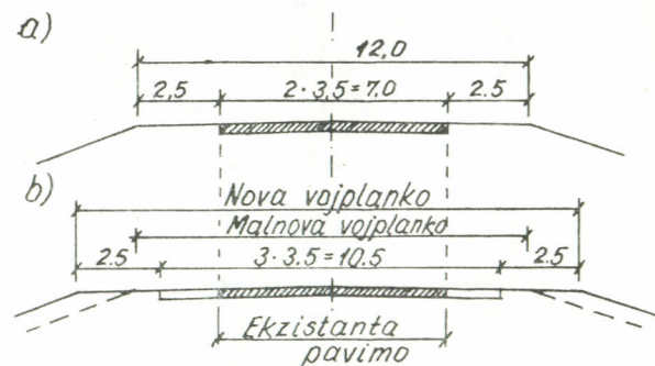
Fig. 4. Ekzempla rekonstruo de duveturlarĝa ŝoseo je tri larĝoj.
